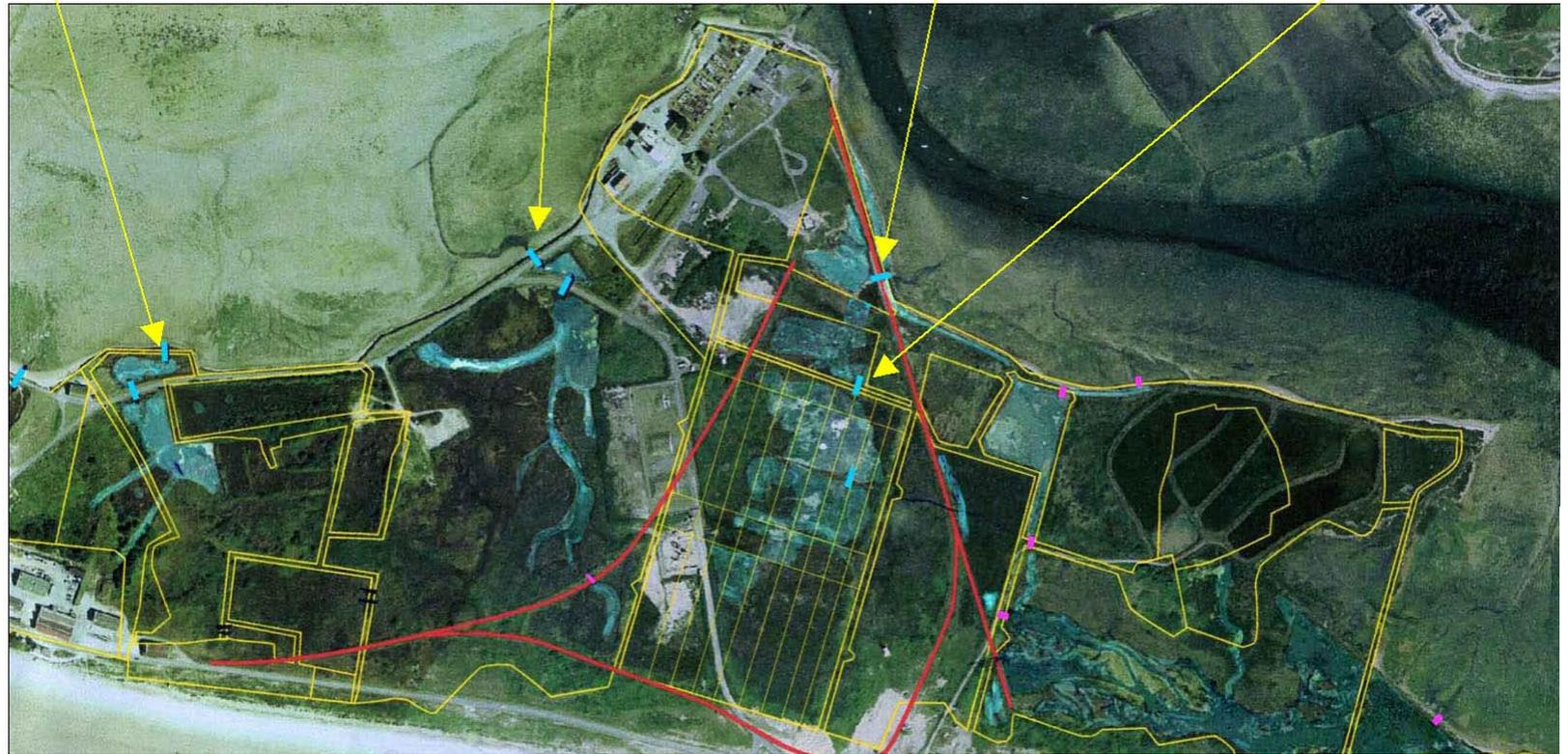
Le site a subi de nombreuses transformations (voies ferrées, route, dépôts de munitions...) qui ont modifié le fonctionnement hydraulique des marais. La circulation de l'eau n'est plus contrôlée (vannages défectueux et brèches dans les digues en raison du manque d'entretien).
